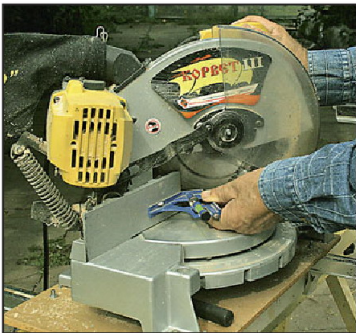
Пильный диск маятниковой пилы нужно выставить точно на угол 45°.
