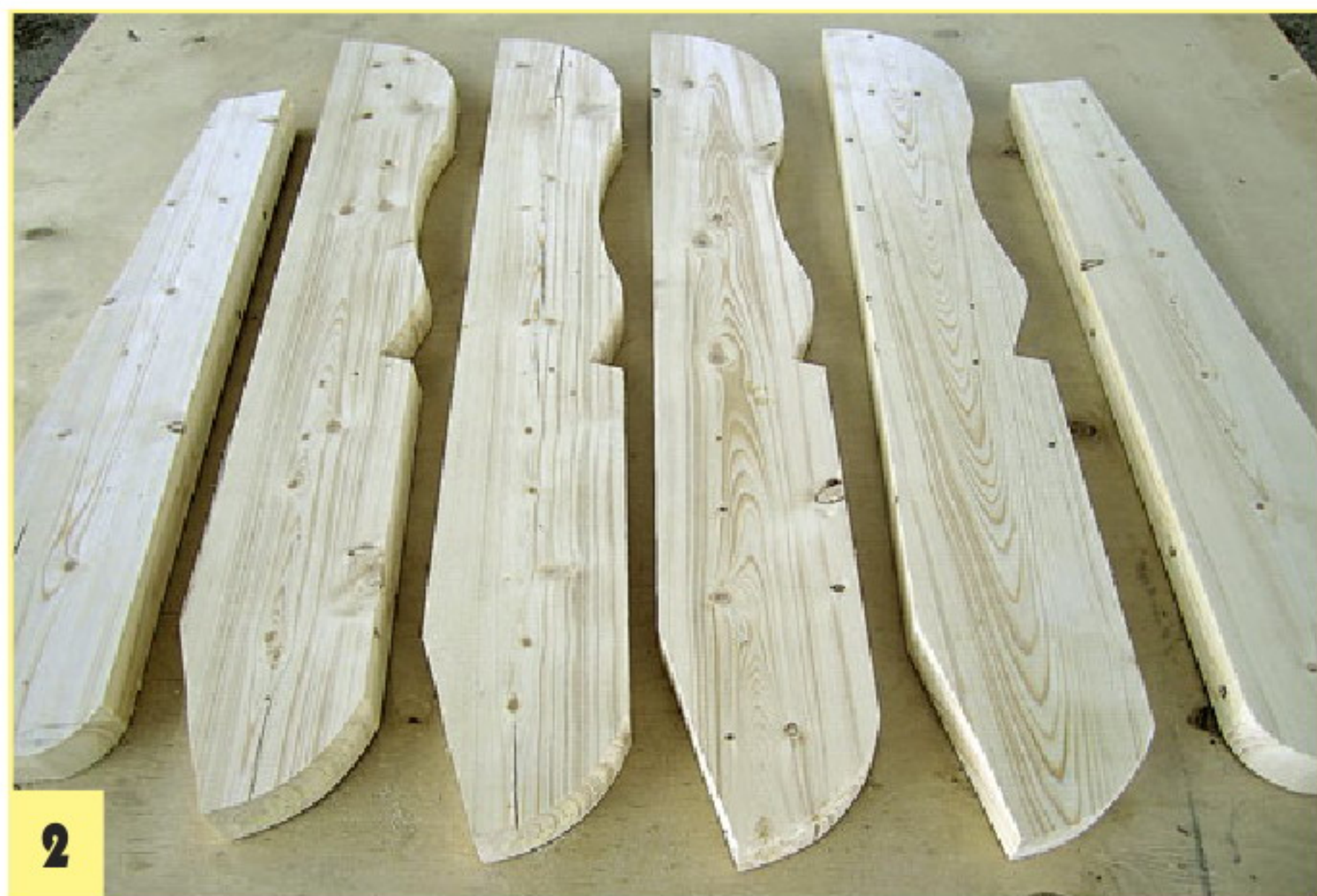
Из досок по разметке выкроил детали.
