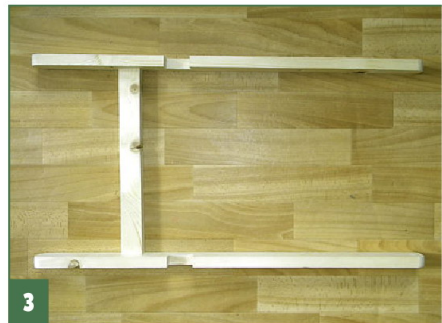
3 «Внутренние» ножки соединены перемычкой. В них предусмотрены пазы под перемычку «внешних» ножек.
