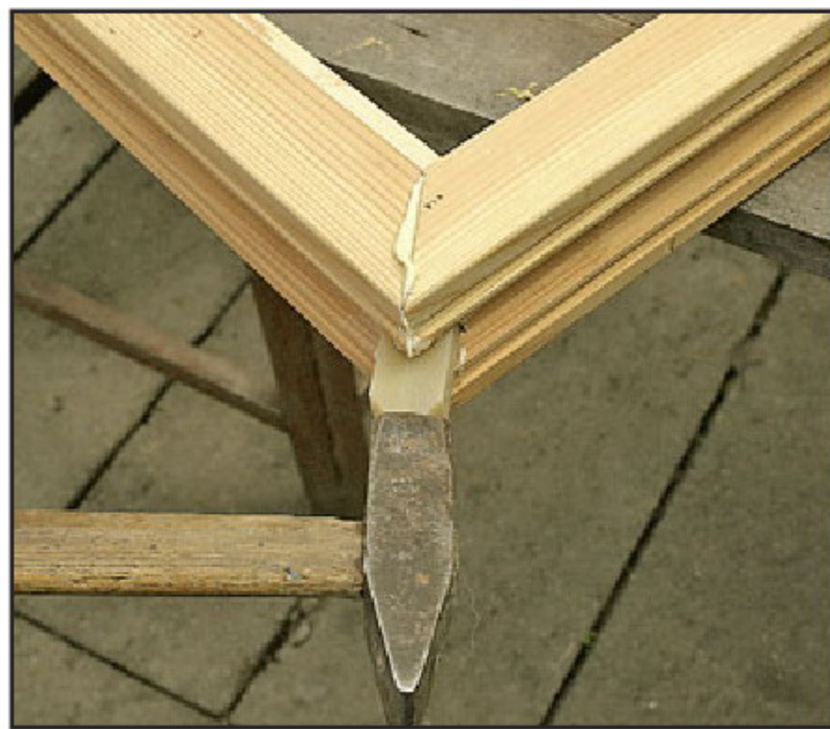
После забивания шпонки в подготовленные пазы, промазанные клеем, угловое соединение рамы становится прочным и неразъёмным.
