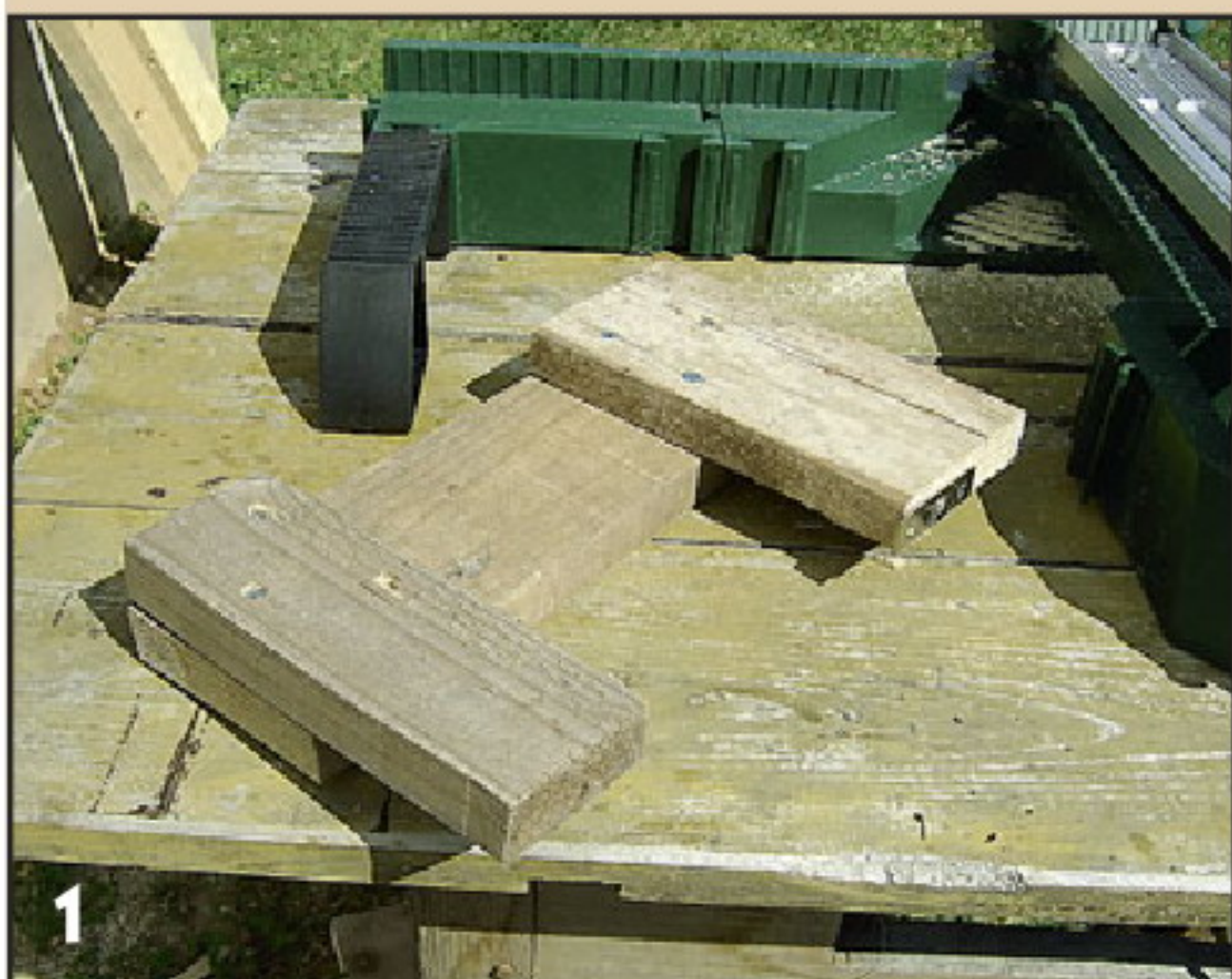
1 Приспособление должно обладать достаточной жёсткостью, чтобы его ножки не расходились под весом бруска и всегда оставались перпендикулярными перемычке.
