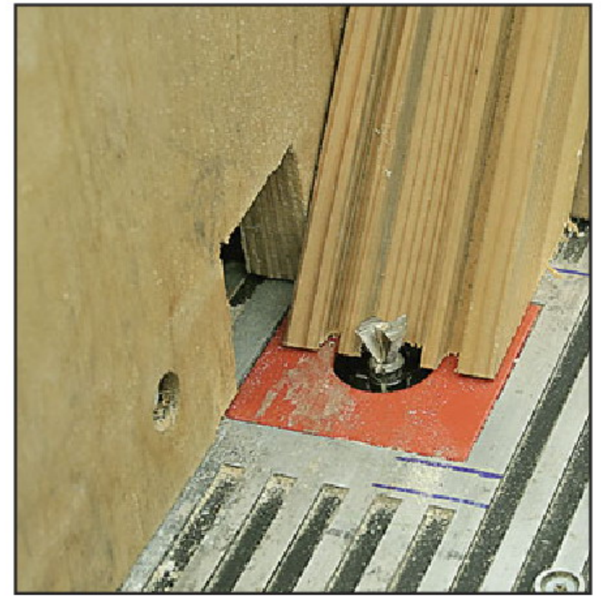
Фреза Хоффмана выставлена, а на стол нанесены ограничительные отметки, определяющие длину паза.
