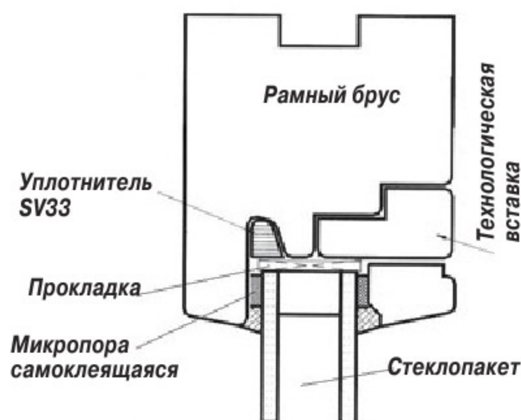
Рис. 3. Сопряжение рамного бруса и стеклопакета в глухом окне.
