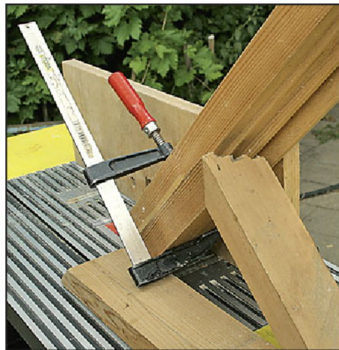
Брус для рамы крепится к приспособлению струбциной так, чтобы скошенный торец плотно прилегал к рабочему столу.
