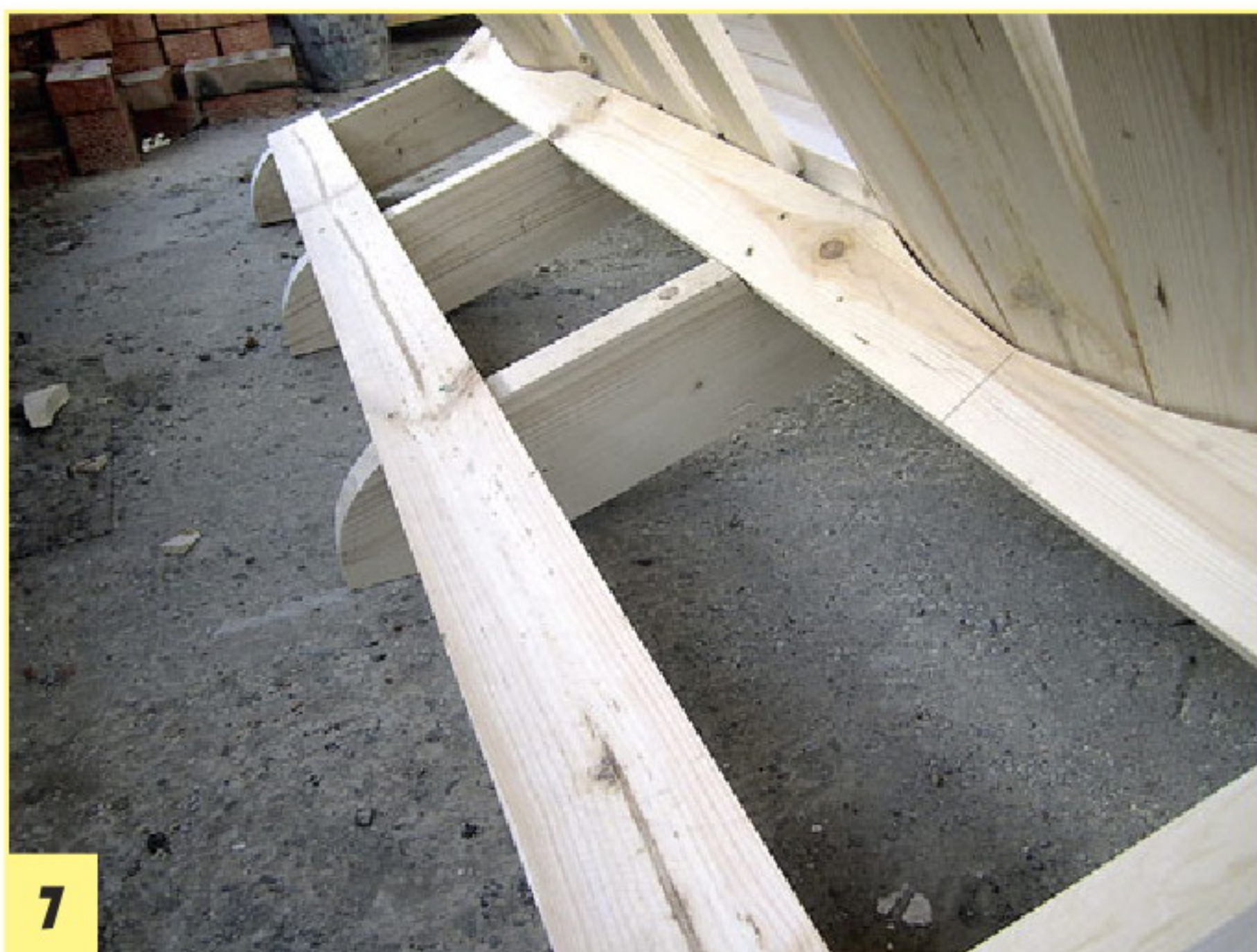
7 Планки спинки монтируются на вырезах в верхнем упоре и средней перемычке.
