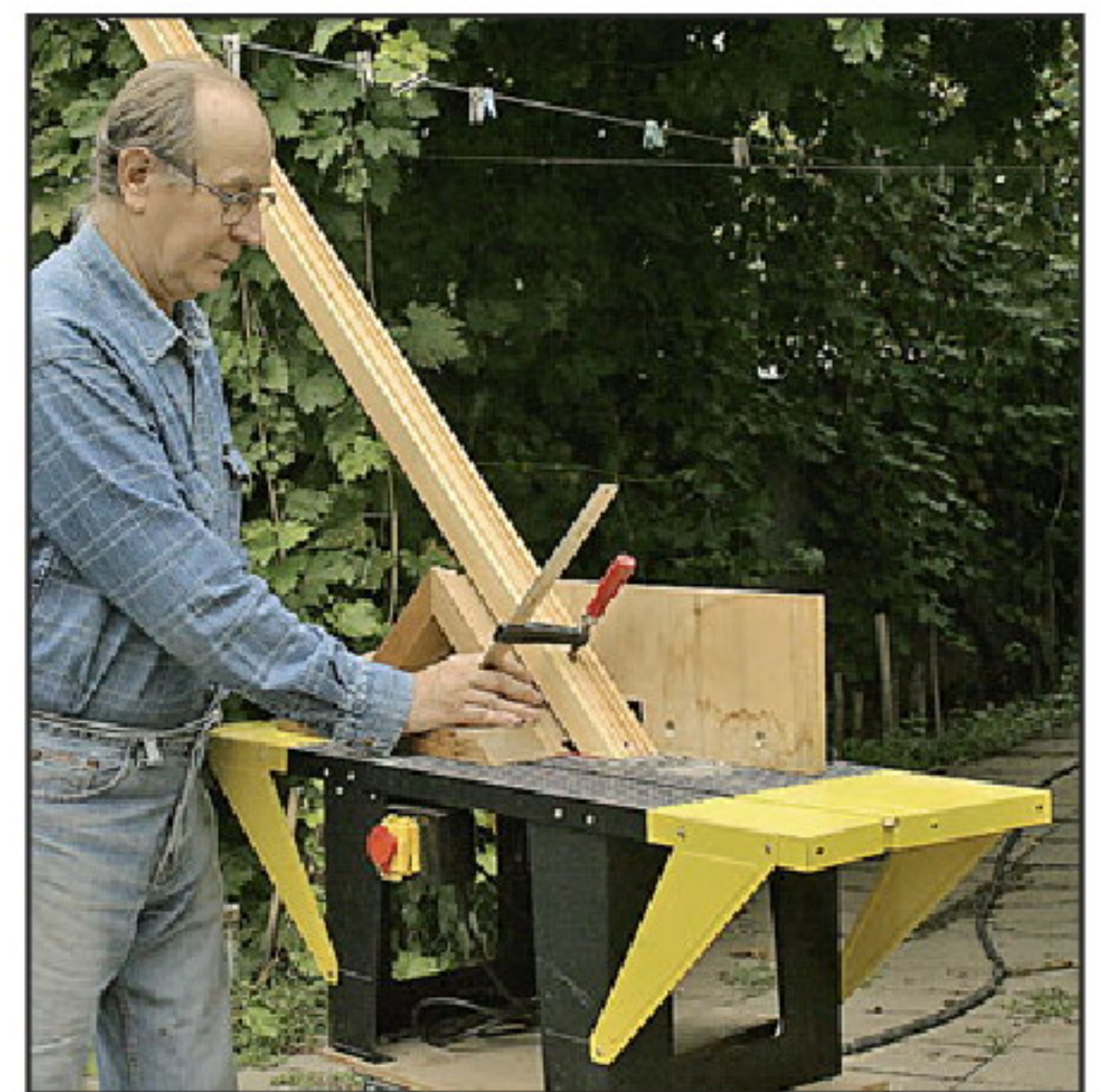
При фрезеровании паза обработку необходимо прекратить у ограничительной отметки, иначе паз может получиться сквозным.
