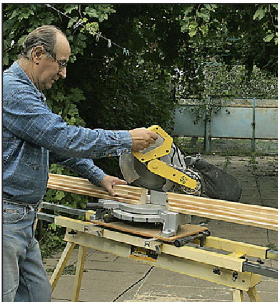
Когда пила хорошо настроена, запиливать концы профилированного бруса на ус уже несложно.
