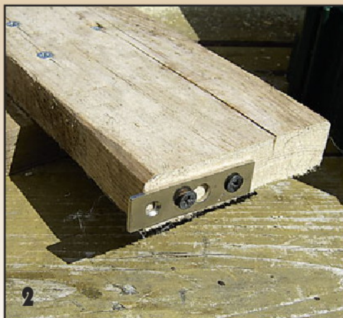
2 Длина верхней ножки (от перемычки до фиксатора) должна равняться суммарной толщине лаги и бруска. Тогда не будет перекоса при установке приспособления. А нижнюю его ножку можно сделать и чуть короче.
