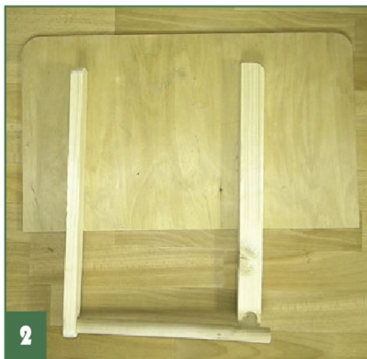
2 «Внутренние» опорные бруски столешницы будут соединены ручкой для переноски стола.
