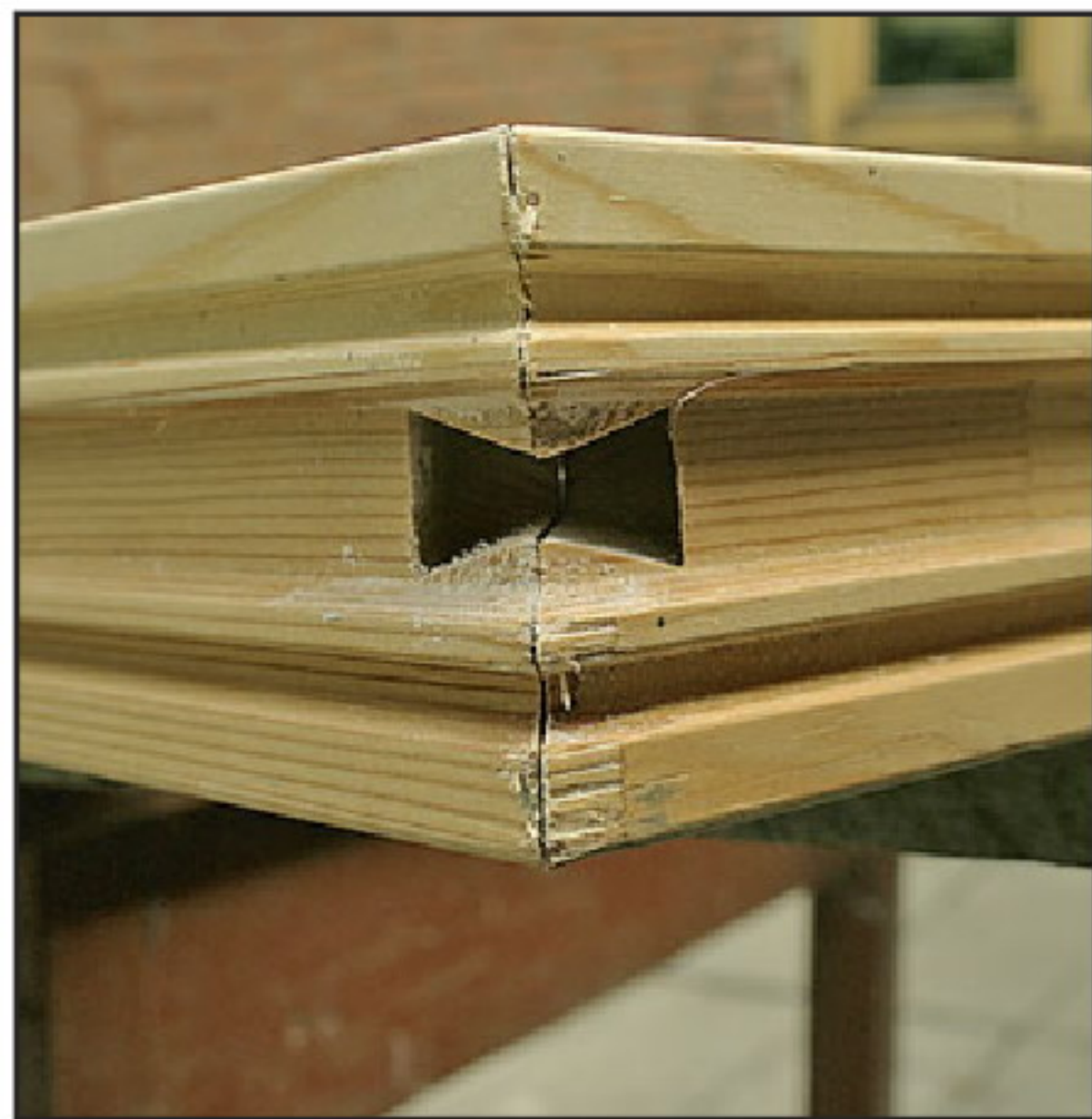
Детали рамы подготовлены к склеиванию.
