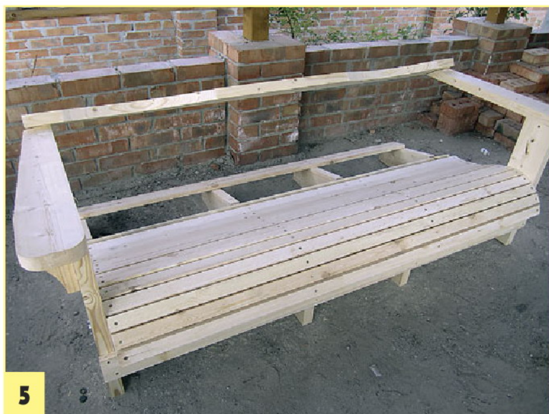
На боковых стойках монтируются подлокотники, которые сзади соединены упором для планок спинки диванчика.
